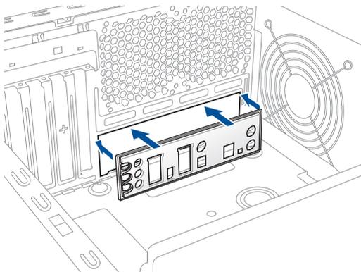
2. Placez la carte mère dans le châssis en vous assurant que ses ports d'E/S (entrée/sortie) sont alignés avec la zone d'E/S du châssis.
