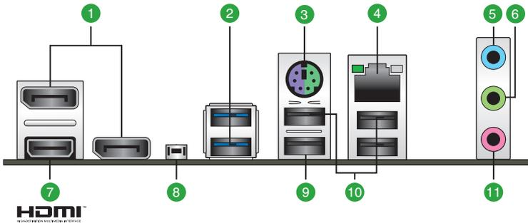
1. **DisplayPort-Anschluss.** Diese Anschlüsse sind für DisplayPort-kompatible Geräte.
