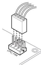
Pour désinstaller l'ensemble ventilateur-dissipateur
