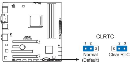
Jumper d'effacement de la mémoire RTC de la F2A85-M
