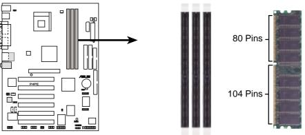
P4PE 184-Pin DDR DIMM Sockets
