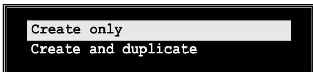
3. Sélectionnez l'option et pressez **<Entrée>**. L'écran reviendra sur les éléments du Menu Créer Matrice. A partir de ce point, vous pouvez choisir de configurer automatiquement la matrice RAID en choisissant **Auto Setup for Data Security** ou de configurer manuellement la matrice RAID pour les ensembles en miroir. Si vous souhaitez configurer manuellement la matrice RAID, poursuivez à l'étape suivante, dans le cas contraire passez à l'étape 5.
