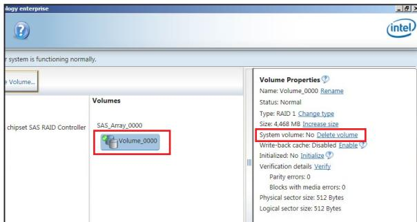
2. 「ボリュームプロパティ」に表示される「システムボリューム」欄にある[ボリュームの削除]をクリックします。
