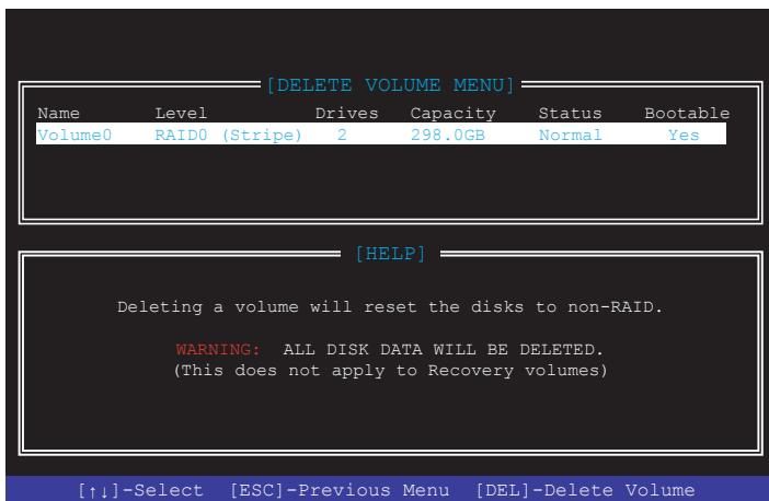
3. 確認画面が表示されたら<Y>を押してRAIDボリュームの削除を実行します。
