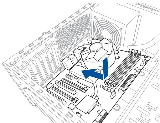
3. 下図を参考に、取り付けるネジをすべて仮止めし、対角線上に少しづつ締めていきます。
