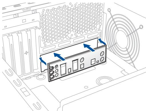
2. I/Oシールドとマザーボードのバックパネルの位置が合っていることを確認し、スペーサーとマザーボードのネジ穴を合わせるように正しい位置に設置します。
