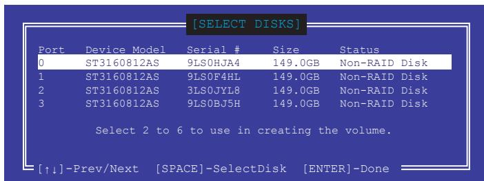
5. RAIDボリュームに使用するドライブを選択したら、<Enter>を押します。
