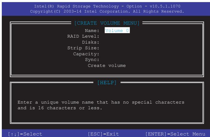
3. 「RAID Level」ではRAIDレベルを選択し、<Enter>で確定します。
