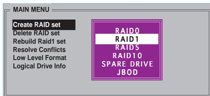
2. Wählen Sie **RAID 1** und drücken anschließend die <Eingabetaste>. Das folgende Fenster wird geöffnet.
