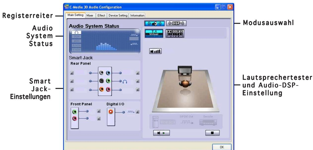
**Audiosystemstatus.** Dieser Abschnitt zeigt den Status des Ausgabemodus, das Echtzeit-Audiowiedergabespektrum und den Digital-E/A-Status an. Die Anzahl der im System konfigurierten Lautsprecher entscheidet den Status des Ausgabemodus.
