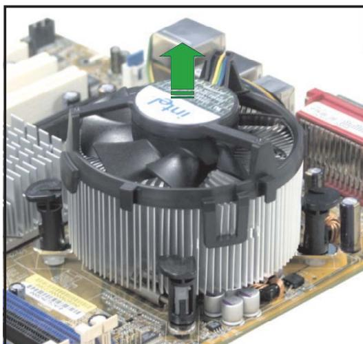
5. Drehen Sie jeden Druckstift im Uhrzeigersinn, um eine richtige Ausrichtung bei Neuinstallation sicherzustellen.
