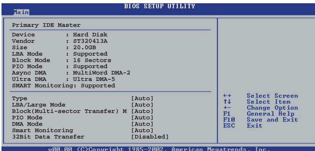
Die Werte neben den mit gedämpfter Farbe dargestellten Elementen (Device, Vendor, Size, LBA Mode, Block Mode, PIO Mode, Async DMA, Ultra DMA, und SMART monitoring) werden vom BIOS automatisch ermittelt und sind nicht benutzereinstellbar. "N/A" wird angezeigt, wenn kein IDE-Gerät in diesem System installiert wurde.
