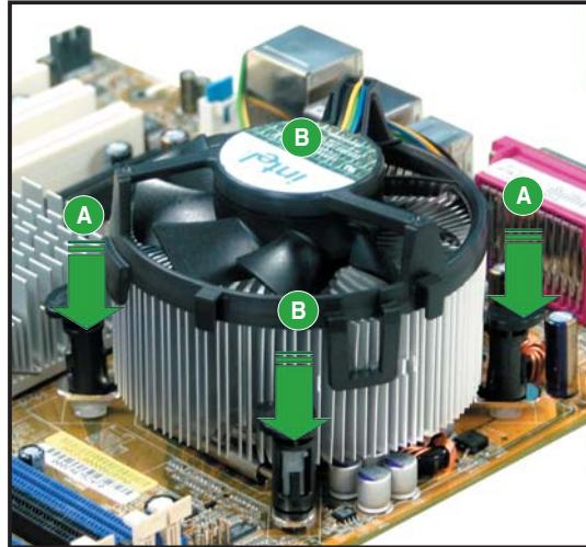
3. Wenn die Kühlkörper-Lüfter-Einheit befestigt ist, verbinden Sie das CPU-Lüfterkabel mit dem CPU\_FAN-Anschluss am Motherboard.
