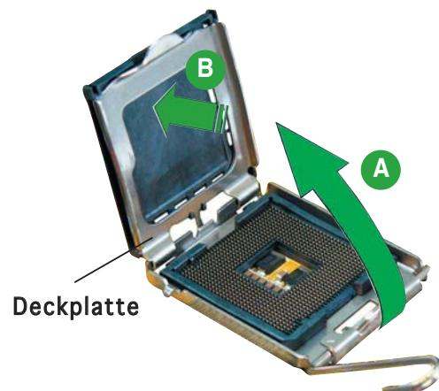
5. Legen Sie die CPU auf den Sockel. Richten Sie dabei das goldene Dreieck auf die untere linke Ecke des Sockels aus. Die Sockelausrichtungsnase muss in die CPU-Kerbe einpassen.
