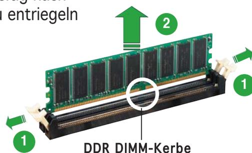
2. Entfernen Sie das DIMM-Modul vom Steckplatz.
