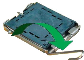
4. Heben Sie die Deckplatte mit dem Daumen und dem Zeigefinger bis zu einem Winkel von 100 Grad hoch (A). Drücken Sie die PnP-Abdeckung von der Deckplattenaussparung, um sie zu entfernen (B).
