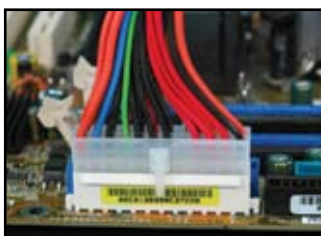
主板使用 24-pin 电源输入
