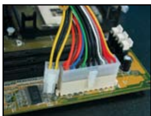
主板使用 20-pin 电源输入
