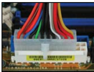
20-poliger Stromanschluss (auf einem 24-poligen weiblicher Gegenstecker)
