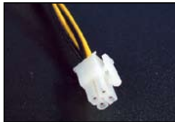
4-poliger ATX-Anschluss
