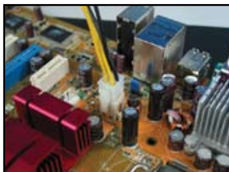
4-poliger Stromanschluss
