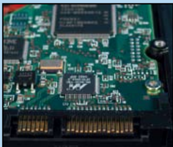
1. SATA 硬碟的信號介面以及電源介面
