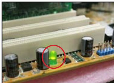
圖 8 主機板電源指示燈
