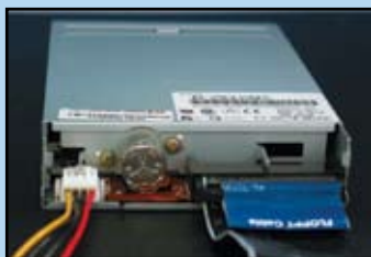
已連接排線的軟碟機
