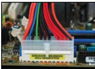
主機板使用 24-pin 電源輸入
