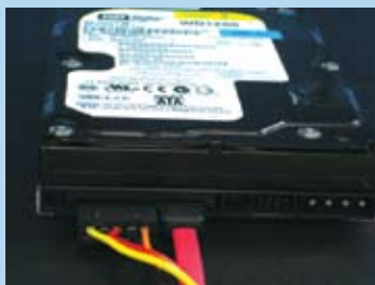
6. 已經插上電源以及信號線的 SATA 硬碟
