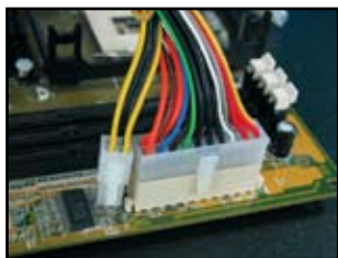
主機板使用 20-pin 電源輸入
