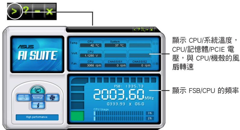
顯示 CPU/系統溫度，CPU/記憶體/PCIE 電壓，與 CPU/機殼的風扇轉速
