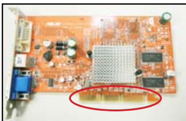
اتصالات طلایی کارت VGA
