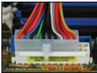
Conector de alimentação de 20 pinos (encaixa na ranhura do conector de 24 pinos)
