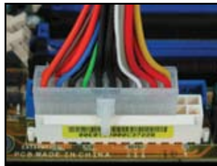
20-pinowe złącze zasilania (na 24-pinowym złączu żeńskim)
