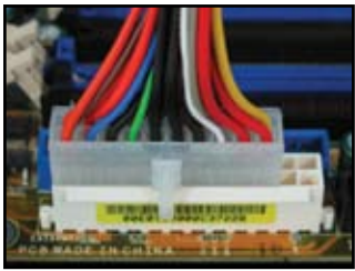
20-pin power connector (Konektor daya 20-pin) (pada 24-pin female counterpart (penompong dalam 24-pin))
