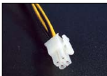
4 érintkezős ATX csatlakozó
