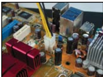
4kolíkový konektor napájení
