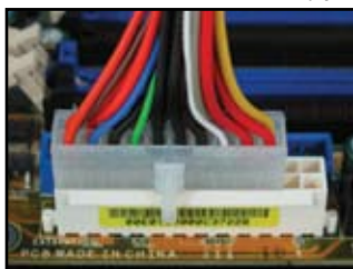
20-и контактный разъем питания (подключен к 24-х контактному разъему )
