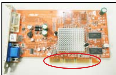
VGA card gold contact (kontak emas kartu VGA)
