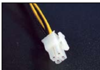
conectorul ATX cu 4 portizolatori
