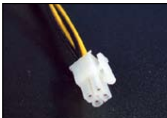
Conector ATX de 4 pins
