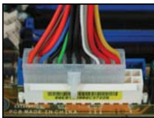
Conector de alimentación de 20 pins (en su correspondiente conector hembra de 24 pins)
