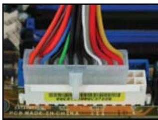
20 érintkezős tápcsatlakozó (a 24 érintkezős hüvelyen)
