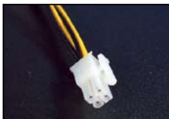
4-х контактный ATX разъем
