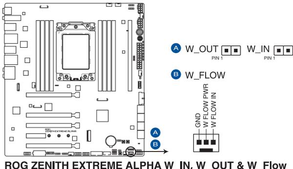
10. 水冷接口 (9-pin WB\_SENSOR)
