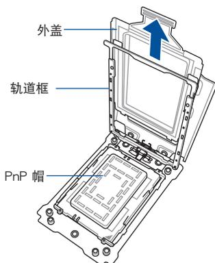
4 将载有 CPU 的托架放入轨道框中，直至听到咔声，然后再卸除 PnP 帽。
