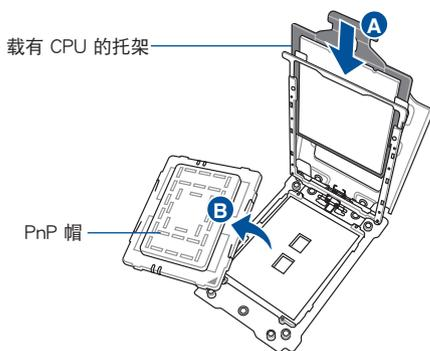
5 轻轻地将轨道框放回原位，直至锁回其插槽外壳，然后再按下压板。
