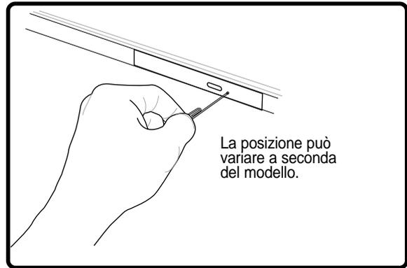
L'espulsione di emergenza è localizzata in un foro sul lettore ottico e viene utilizzata per espellere il cassetto del lettore ottico nel caso in cui l'espulsione elettrica non dovesse funzionare. Non utilizzare l'espulsione di emergenza al posto dell'espulsione elettronica. **NOTA: Assicurarsi di non danneggiare l'indicatore di attività situato nella stessa zona.**
