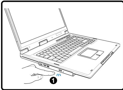
1. Drücken Sie bei eingeschaltetem Notebook die Auswurf-taste, fährt der Laufwerksträger ein Stück aus.
