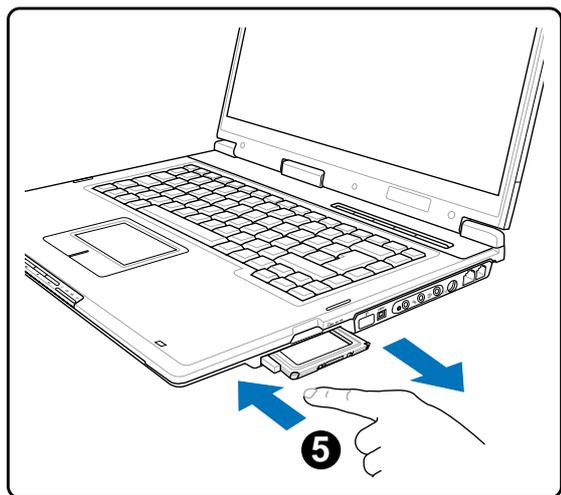
1. Drücken Sie die Auswurf-taste hinein und lassen sie wieder los. Die Federtaste kommt heraus, wenn sie hineingedrückt und wieder losgelassen wird.
