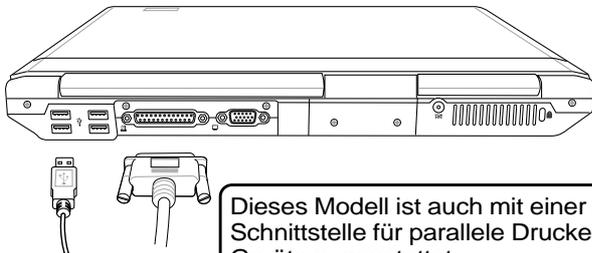
Dieses Modell ist auch mit einer parallelen Schnittstelle für parallele Drucker oder Geräte ausgestattet.
