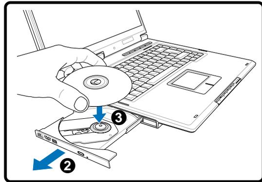
2. Ergreifen Sie die Vorderseite des Trägers und ziehen Sie ihn vorsichtig bis zum Anschlag heraus. Achten Sie dabei darauf, nicht die Linse und die mechanischen Teile des optischen Laufwerks zu berühren. Vergewissern Sie sich, dass sich keine Gegenstände unter dem Laufwerksträger befinden, die ihn festklemmen könnten.
