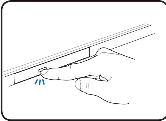
2. Ergreifen Sie die Vorderseite des Trägers und ziehen Sie ihn vorsichtig bis zum Anschlag heraus. Achten Sie dabei darauf, nicht die Linse und die mechanischen Teile des optischen Laufwerks zu berühren. Vergewissern Sie sich, dass sich keine Gegenstände unter dem Laufwerksträger befinden, die ihn festklemmen könnten.
