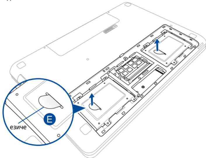
E. (Като опция) Ако към HDD кутия има прикрепен HDD, вижте следните стъпки относно премахване на стария HDD:
