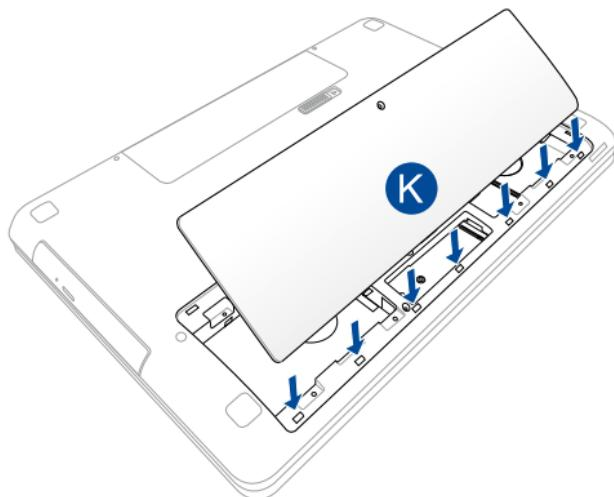
Л. Закрепете и подсигурете капака на батерийния модул чрез болта, който отстранихте по-рано.
