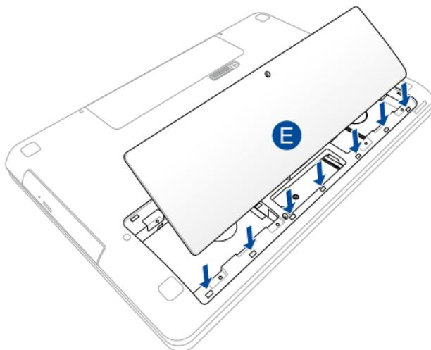
Е. Закрепете и подсигурете капака на батерийния модул чрез болта, който отстрихните по-рано.
