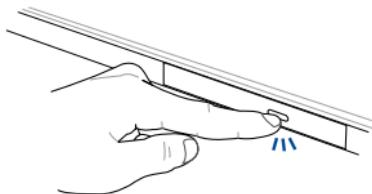
2. 請將光碟機托盤完全拉出。
