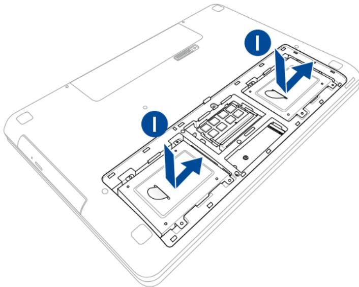
J. 重新鎖回之前移除的螺絲以固定硬碟托架。
