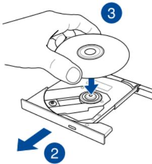
4. 將光碟片中央的塑膠圈環向下壓直到與光碟機托盤完全接合。
