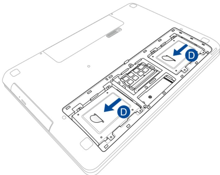
E. 使用硬碟托架的摺板將硬碟托架自插槽中拉出。
