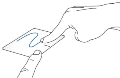
选择图标之后按住左键，然后用另一根手指在触摸板滑动拖曳该图标，然后放开图标将其放置于新的位置。
