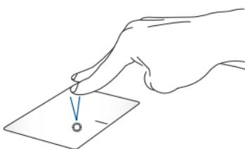
用两只手指在触摸板上点击 / 轻触以模拟鼠标右键功能。
