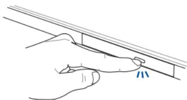
2. 请将光驱托盘完全拉出。
