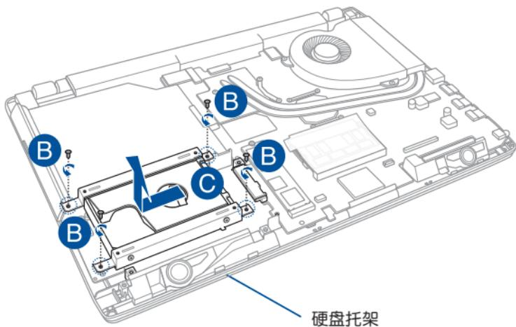
D. (选配) 若硬盘与硬盘托架连接, 请参考下列步骤移除旧硬盘:
