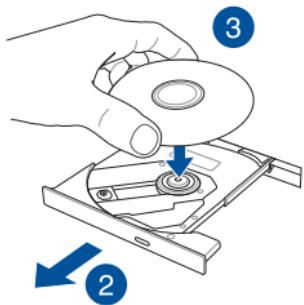
4. 将光盘中央的塑胶圈环轻轻向下压直到与光驱托盘完全接合。
