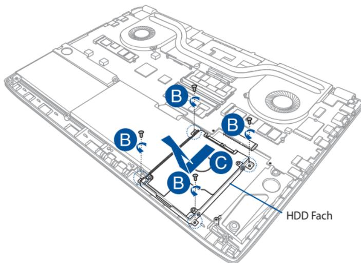
D. (Optional) Falls aktuell eine Festplatte im Festplattenschacht angebracht ist, beachten Sie die nachstehenden Schritte zum Entfernen der alten Festplatte:
