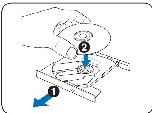
3. Segure o disco pela extremidade e vire o lado impresso do disco para cima. Prima ambos os lados do centro do disco até o disco encaixar no hub. **O hub deve ser mais alto do que o disco quando é montado correctamente.**
