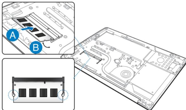
8. Подравнете жлебовете на металния предпазител на DIMM с металните скоби около DIMM гнездото, след което поставете обратно металния предпазител на DIMM модула.
