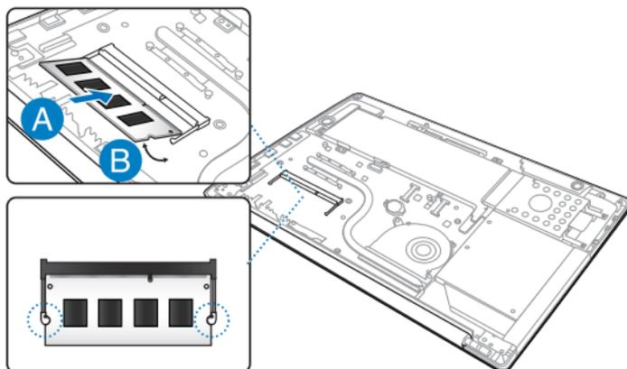
8. Alinee las muescas del protector metálico del módulo DIMM con las abrazaderas metálicas que rodean la ranura de dicho módulo y, a continuación, vuelva a acoplar el protector mencionado.
