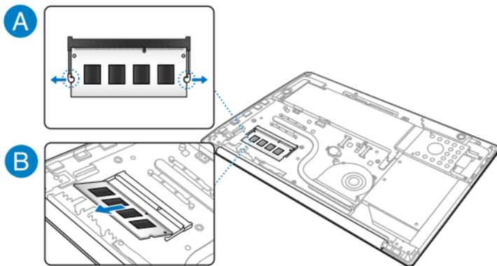
7. Alinee e inserte el nuevo módulo DIMM en la ranura (A) y presiónelo hacia abajo (B) hasta que quede asentado de forma segura su lugar.
