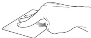
3本の指先をタッチパッド上で下方向にスライドし、デスクトップを表示します。
