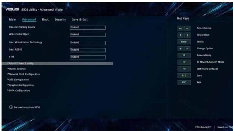
6. フラッシュドライブに保存したBIOSファイルを参照し、
