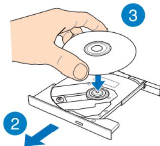
3. Segure o disco pela borda, com o lado impresso para cima, em seguida, delicadamente coloque-o dentro do cubo.
