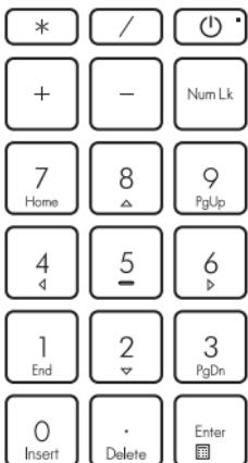
モデルによってはテンキーが搭載されています。テンキーは数字の入力と方向キーでの操作が可能です。
