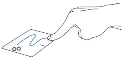
項目をダブルタップし、そのままスライドします。指先をタッチパッドから離すと、ドロップされます。
