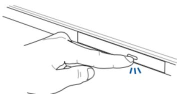
2. ドライブのフロントパネルをそつと引きながら、トレイをスライドさせて完全に出します。
