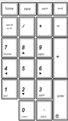
モデルによってはテンキーが搭載されています。テンキーは数字の入力と方向キーでの操作が可能です。
