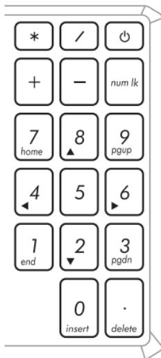
モデルによってはテンキーが搭載されています。テンキーは数字の入力と方向キーでの操作が可能です。
