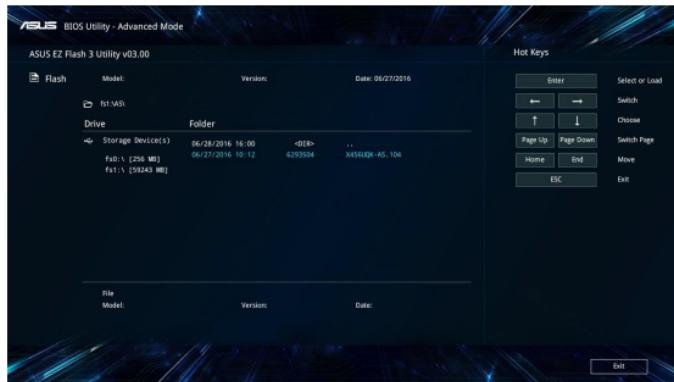
7. BIOS更新後、「**Save & Exit**」→「**Restore Defaults**」の順に選択し、システムにデフォルト設定をロードします。
