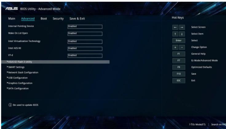
6. フラッシュドライブに保存したBIOSファイルを参照し、
