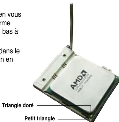
5. Lorsque le CPU est en place, abaissez le levier pour sécuriser le CPU. Un léger cliquetis se fait entendre indiquant que le CPU est bien verrouillé.
