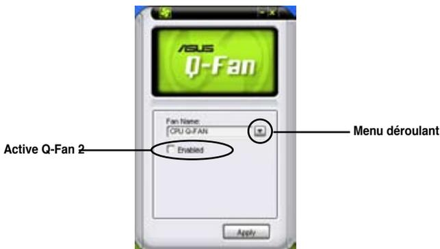
Une liste de profils apparaît après avoir coché la case **Enable Q-Fan 2**. Cliquez sur le menu déroulant et sélectionnez un profil. Le mode **Optimal** ajuste la vitesse des ventilateurs selon la température; le mode **Silent** réduit la vitesse des ventilateurs pour un fonctionnement silencieux; le mode **Performance** accroît la vitesse des ventilateurs pour un meilleur refroidissement.
