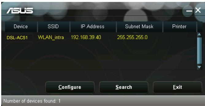
**HINWEIS:** Wenn Sie beim Router den Access Point (Zugangspunkt)-Modus einstellen, müssen Sie die Device Discovery (Geräteerkennung) verwenden, um die IP-Adresse des Routers zu erhalten.
