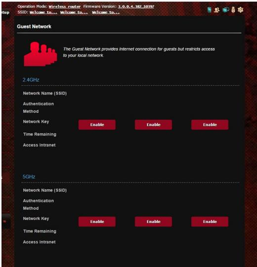
3. ゲストの設定を変更するには、変更したいゲストの設定をクリックします。ゲストの設定を削除するには、「**削除**」をクリックします。
