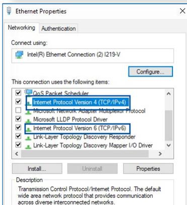
4. DHCP を使用して IP 設定を自動的に取得するには、「IPアドレスを自動的に取得する」をクリックします。
