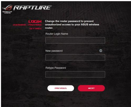
**注意:** 無線LANルーターのログイン名とパスワードは、2.4GHz/5GHzネットワーク名 (SSID)、セキュリティキーとは異なります。無線LANルーターのログインユーザー名とパスワードは無線LANルーターのWeb GUIにアクセスする際に使用するものです。2.4GHz/5GHzネットワーク名 (SSID) とセキュリティキーは、Wi-Fi デバイスで2.4GHz/5GHzネットワークにログインし接続する際に使用します。
