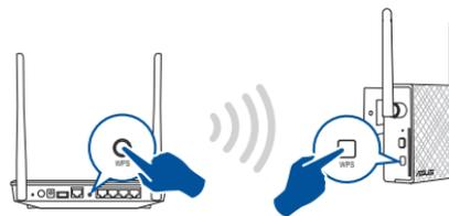
3. Compruebe si el indicador Wi-Fi de su RP-N12 se ilumina permanentemente, lo que indica que el prolongador de alcance se ha conectado a la red inalámbrica correctamente. El nombre de red inalámbrica (SSID) del prolongador de alcance cambia al nombre de red Wi-Fi existente, que termina por **\_RPT**. Por ejemplo:
