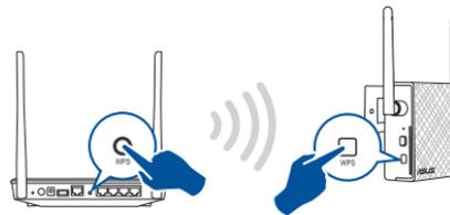
3. Jakmile Wi-Fi indikátor prodlužovače dosahu RP-N12 začne trvale svítit, znamená to, že se prodlužovač dosahu úspěšně připojí k bezdrátové síti. Název bezdrátové sítě (SSID) prodlužovače dosahu se změní na stávající název vaší sítě Wi-Fi s koncovkou **\_RPT**. Například:
