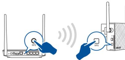
3. Skontrolujte, či indikátor Wi-Fi zariadenia RP-N12 začne svietiť nepretržite, čo znamená, že zariadenie na zlepšenie dosahu sa úspešne pripojilo k bezdrôtovej sieti. Názov bezdrôtovej siete (SSID) zariadenia na zlepšenie dosahu sa zmení na názov existujúcej siete Wi-Fi, ktorý bude mať na konci **\_RPT**. Napríklad:
