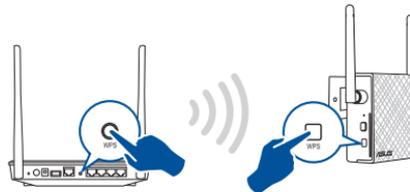
3. Vérifiez que le témoin Wi-Fi du répéteur est allumé, indiquant que la connexion a été établie. Le SSID du répéteur est remplacé par celui du réseau Wi-Fi existant, et finissant par **\_RPT**. Par exemple :
