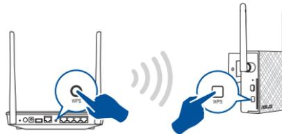
3. Ελέγξτε αν η ενδεικτική λυχνία Wi-Fi του RP-N12 ανάβει μόνιμα, γεγονός που υποδεικνύει ότι η συσκευή επέκτασης εύρους έχει συνδεθεί με επιτυχία στο ασύρματο δίκτυο. Το όνομα ασύρματου δικτύου (SSID) της συσκευής επέκτασης εύρους αλλάζει στο τρέχον όνομα δικτύου Wi-Fi, με την κατάληξη **\_RPT**. Π.χ.:
