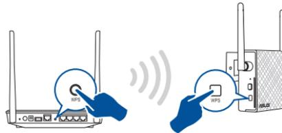
3. Controleer of de wifi-indicator van de RP-N12 stabiel oplicht, wat aangeeft dat de Range Extender een verbinding heeft gemaakt met het draadloos netwerk. De naam van het draadloze Range Extender-netwerk (SSID) verandert naar de bestaande wifi-netwerknnaam, eindigend met **\_RPT**. Bijvoorbeeld:
