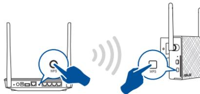
3. Kontroller at Wi-Fi-indikatoren på RP-N12 lyser. Dette indikerer at områdeutvideren er koblet til det trådløse nettverket. Navnet på områdeutviderens trådløse nettverk (SSID) endres til det eksisterende Wi-Fi-nettverksnavnet med endelsen **\_RPT**. Eksempel:
