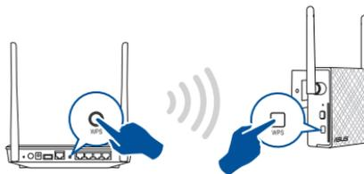
3. Verificate che il LED Wi-Fi dell'RP-N12 sia acceso e fisso per assicurarvi che il range extender si sia connesso con successo alla rete wireless. Il SSID (nome rete wireless) del range extender cambia e assume il nome della vostra rete Wi-Fi esistente con l'aggiunta di **\_RPT** alla fine del nome. Per esempio:
