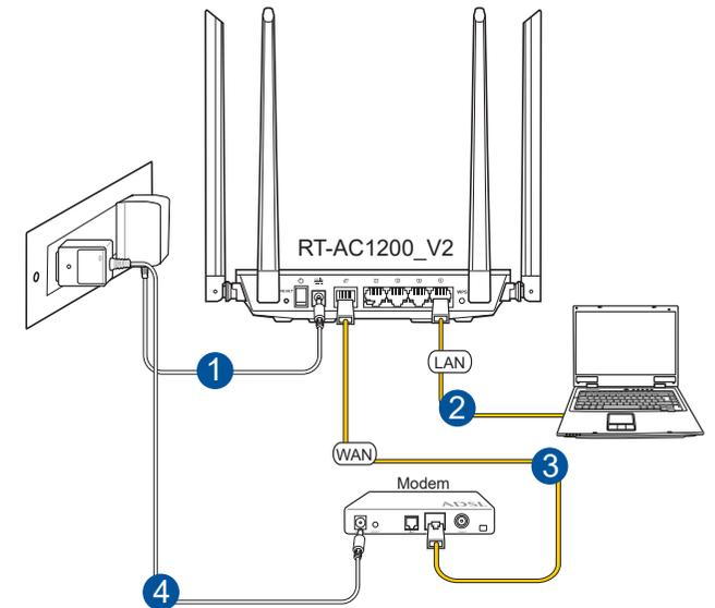
1. 將無線分享器的 AC 變壓器插入電源輸入 (DC-IN) 連接埠並插上電源。
