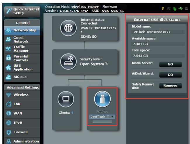
**NOTA:** Para utilizar esta capacidade, tem de ligar um dispositivo de armazenamento USB como, por exemplo, um disco rígido USB ou uma unidade flash USB à porta USB existente na parte de trás do router sem fios. Certifique-se de que o dispositivo de armazenamento USB está corretamente formatado e particionado. Consulte a Lista de Discos Plug-n-Share Suportados em <http://event.asus.com/networks/disksupport>.
