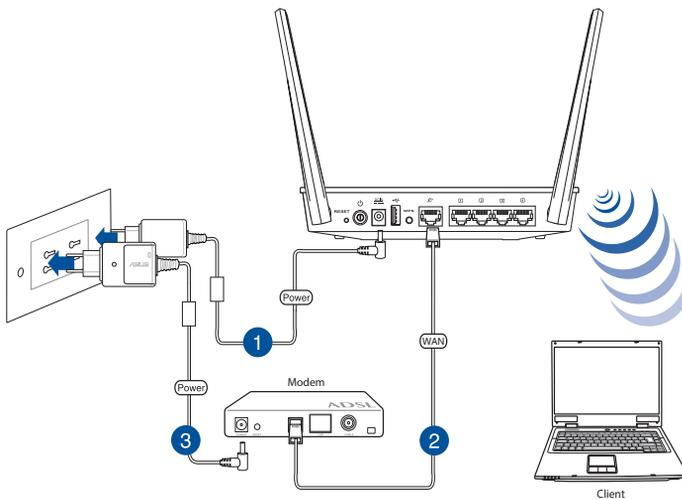
So richten Sie Ihren WLAN-Router über eine WLAN-Verbindung ein:
