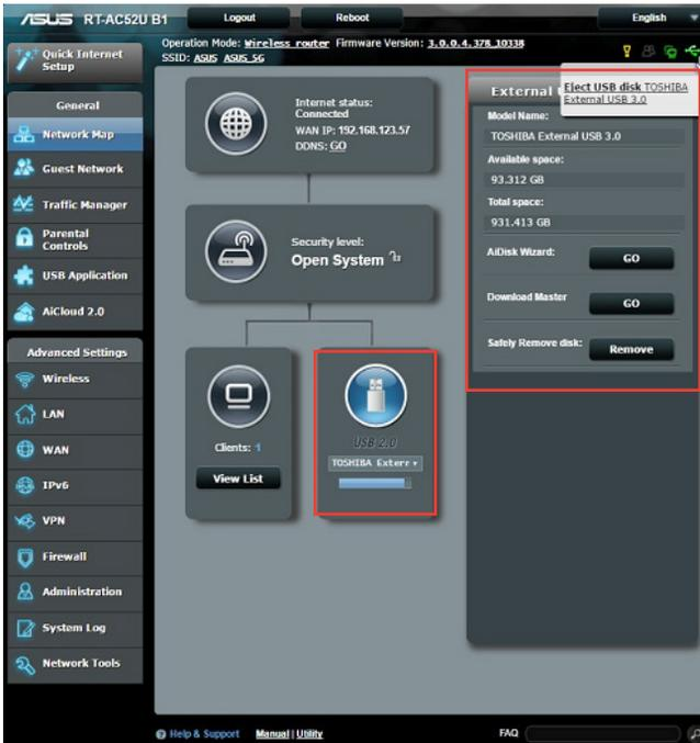
**HINWEISE:** Um diese Funktion zu verwenden, müssen Sie einen USB-Datenträger, wie eine USB-Festplatte oder ein USB-Flashlaufwerk, mit dem USB 2.0 Anschluss auf der Rückseite Ihres WLAN-Routers verbinden. Stellen Sie sicher, dass der USB-Datenträger richtig formatiert und partitioniert wurde. Für eine Liste unterstützter Dateisysteme für Ihre Laufwerke beziehen Sie sich auf die ASUS-Webseite unter <http://event.asus.com/networks/disksupport>
