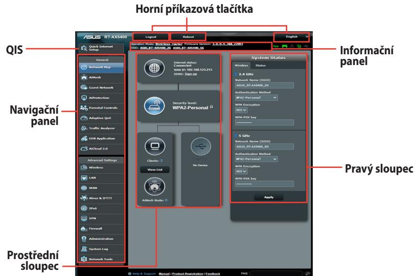
**POZNÁMKA:** Při prvním přihlášení k webovému grafickému uživatelskému rozhraní (GUI) budete automaticky přesměrováni na stránku Rychlého průvodce instalací (QIS).
