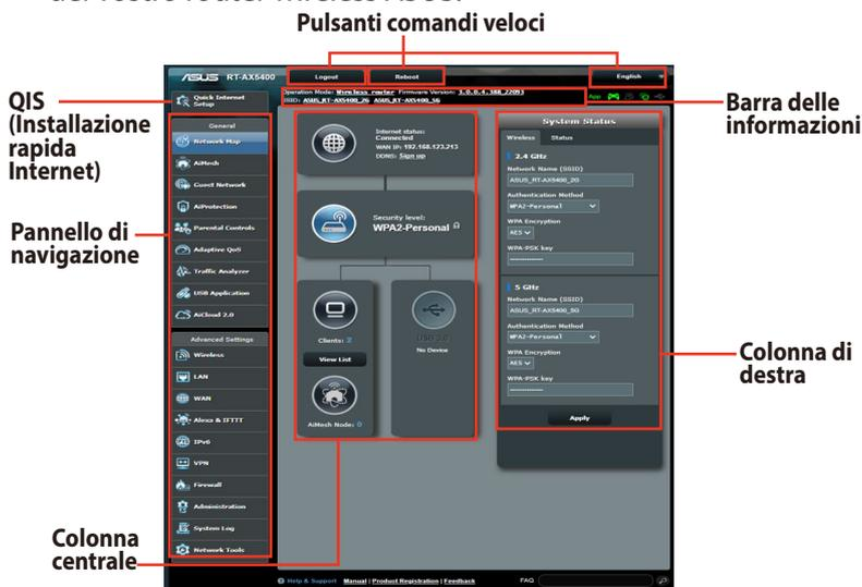
**NOTA:** Al primo accesso all'interfaccia web verrete indirizzati automaticamente all'installazione rapida Internet (QIS).
