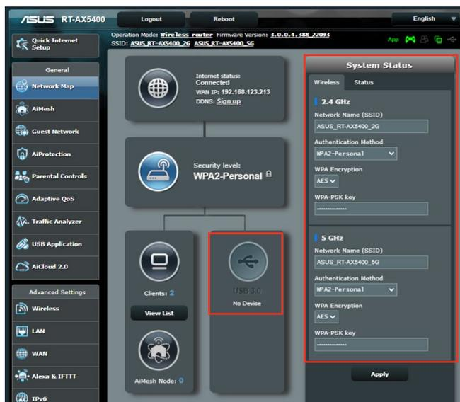
**NOTA:** Per usare questa funzione è necessario inserire un dispositivo di archiviazione USB, come un hard disk USB o una memoria flash USB, nella porta USB 3.0 del pannello posteriore del vostro router wireless. Assicuratevi che il dispositivo di archiviazione USB sia formattato e partizionato correttamente. Fate riferimento all'elenco di dischi Plug-n-Share che trovate sul sito web: <http://event.asus.com/networks/disksupport>.
