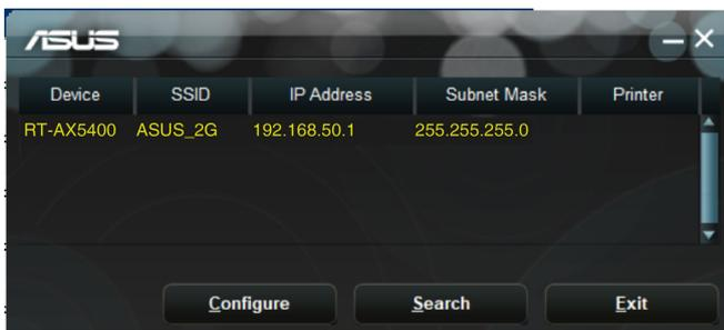
**NOTA:** Quando impostate il router in modalità Access Point avete bisogno di usare Device Discovery per ottenere l'indirizzo IP del router.
