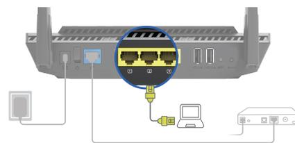
Conectar su PC al router a través de WiFi o utilizando un cable de red adicional (no incluido).
