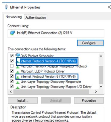
4. Per ottenere automaticamente le impostazioni IPv4 selezionate **Otteni automaticamente un indirizzo IP**.
