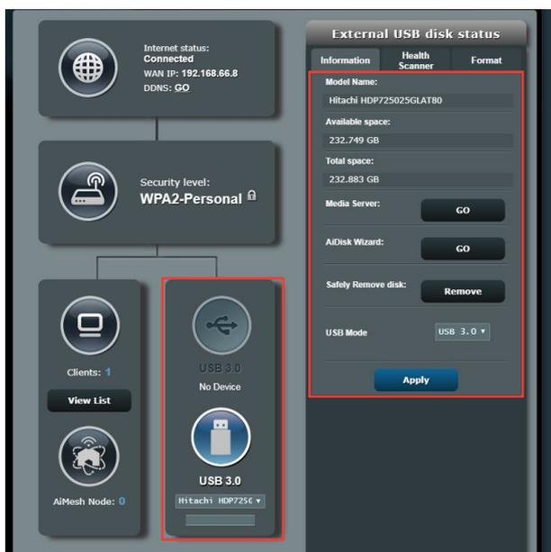
**HINWEIS:** Um diese Funktion zu verwenden, müssen Sie einen USB-Datenträger, wie eine USB-Festplatte oder ein USB-Flashlaufwerk, mit dem USB 3.0 Anschluss auf der Rückseite Ihres WLAN-Routers verbinden. Stellen Sie sicher, dass der USB-Datenträger richtig formatiert und partitioniert wurde. Für eine Liste unterstützter Dateisysteme für Ihre Laufwerke beziehen Sie sich auf die ASUS-Webseite unter <http://event.asus.com/networks/disksupport>.
